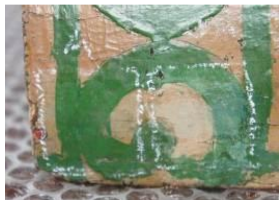
Figura 21 Pruebas de solubilidad con acetona y alcohol en anverso de coraza (espaldar)
