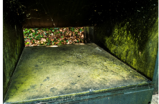
Fig. 25. Materia orgánica (musgo, líquen y polen) adherida al recubrimiento de la escultura.
