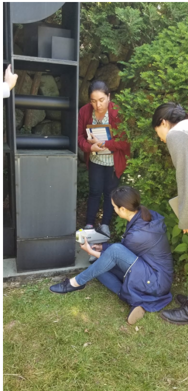
Fig. 18. Realización de análisis cualitativo XRF.
